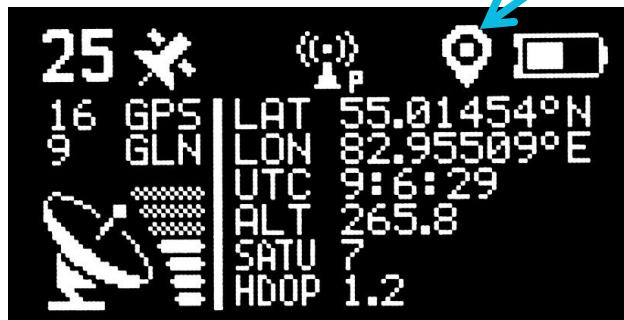
**Левая часть экрана** отображает количество видимых спутников, а также качество сигнала, эта информация валидна всегда при включенной функции определения координат.
