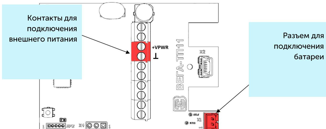
7. При первом подключении питания устройство автоматически переходит в режим «Активный» и приступает к регистрации в сети. Но если устройство с подключенной батареей или внешним питанием было переведено в режим «Склад» длительным (более 5 сек) нажатием на кнопку запуска, то включение осуществляется нажатием на кнопку.
