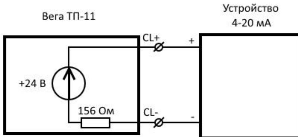
В целях экономии ресурса батареи конвертера питающее напряжение 24 В подаётся не постоянно. Напряжение 24 В подаётся на устройство «4-20 мА» за несколько секунд до выполнения опроса для того, чтобы датчик успел включиться и установить соответствующий измеряемому параметру ток. Это время, так называемое «время прогрева», является настраиваемым из конфигуратора параметром и может устанавливаться от 1 до 60 секунд.
