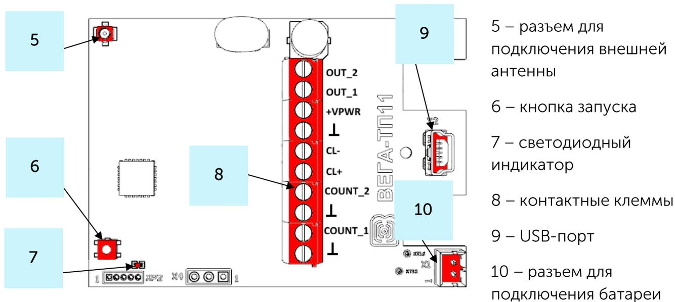
5 – разъем для подключения внешней антенны
