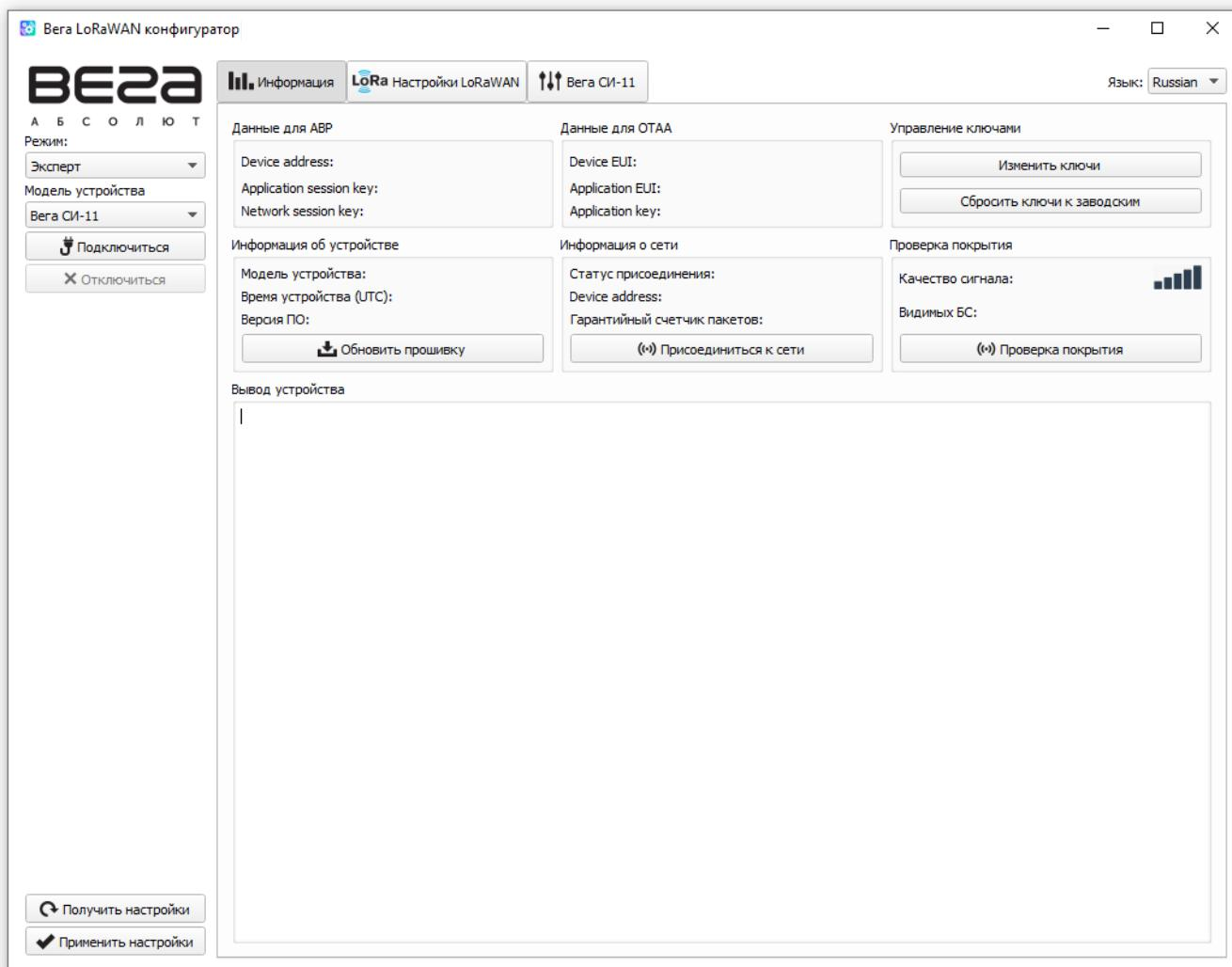
Меню слева позволяет переключаться между режимами работы программы «Простой» и «Эксперт», выбирать модель устройства, осуществлять подключение к устройству или отключиться от него, получать и применять настройки.
