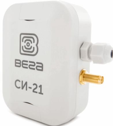
Элементом питания для счетчика служит встроенная батарея ёмкостью 3400 мАч.
