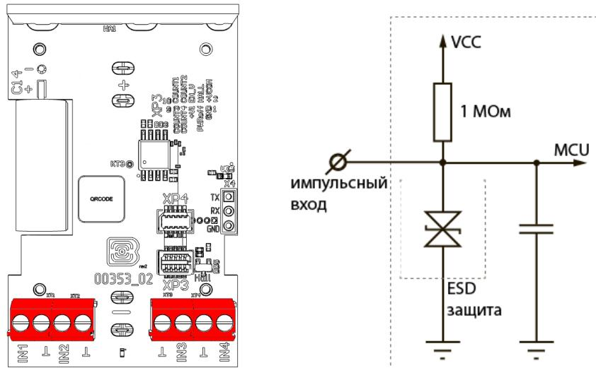
Счетчик импульсов оснащен алгоритмом антидребезга с постоянной времени 5 мс. Подсчет импульсов осуществляется для частот до 200 Гц.
