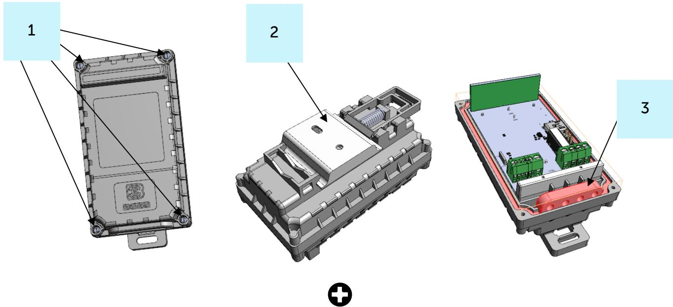
2 – DIN-рейка с монтажными отверстиями Ø 3 мм
