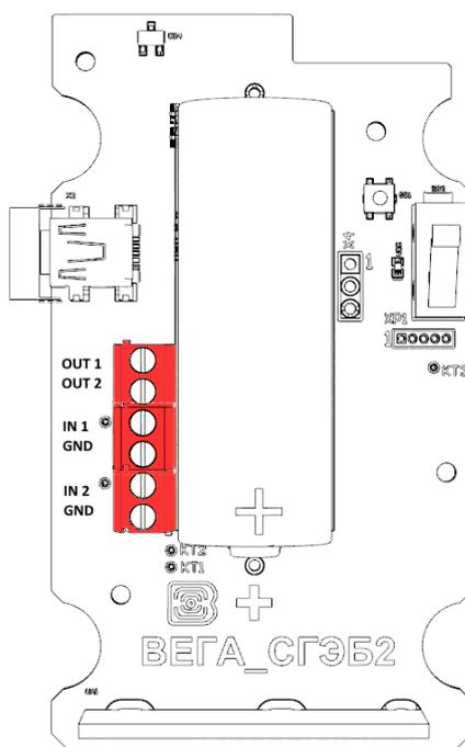
LoRaWAN® модем Beza GM-2 имеет дополнительную возможность подключения двух охранных входов IN1 и IN2, расположенных на плате устройства. Модем следит за их замыканием или размыканием, в зависимости от заданных настроек в программе «Vega LoRaWAN Configurator». В случае срабатывания охранного входа устройство активируется и отправляет в сеть сообщение с сигналом тревоги.
