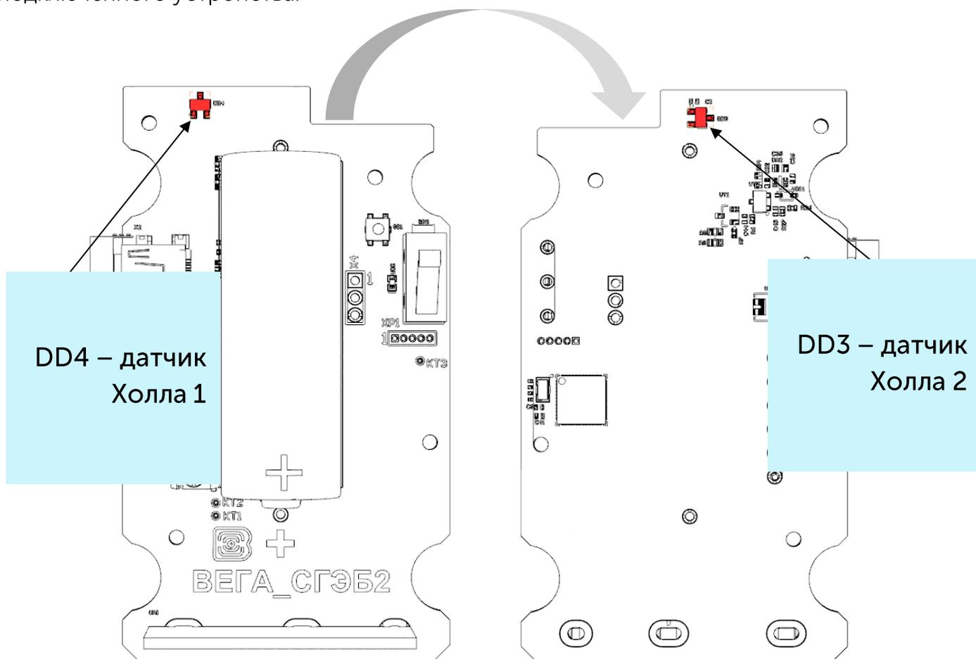
На верхней стороне платы расположен датчик вскрытия корпуса или тампер. При срабатывании датчика Холла 1 и/или тампера в сеть LoRaWAN® отправляется пакет с соответствующим сообщением.
