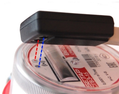
Р и с у н о к 8 — Расположение адаптера «Оптопорт-USB» относительно счетчика_Крупный план
