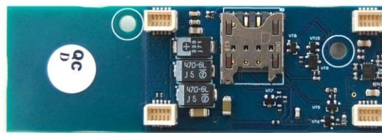
SIM-карта формата micro-SIM вставляется в гнездо, после чего модуль GSM устанавливается на прежнее место.
