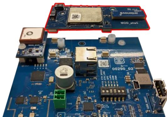
Гнездо для SIM-карты расположено с обратной стороны модуля. Чтобы установить SIM-карту, необходимо отсоединить модуль GSM от основной платы и перевернуть его.
