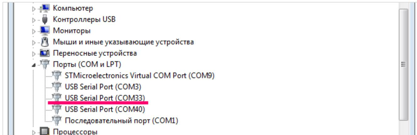
После этого открыть программу PuTTY, выбрать способ подключения Serial, и ввести номер виртуального COM-порта базовой станции и скорость (115200) в соответствующие поля.
